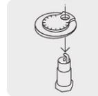
Agujero diseñado para ajustar el alambre de la bujía sin hacer presión al electrodo central
