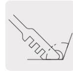
Ángulo de corte de 130° permite cortar vidrios de hasta 10 mm
