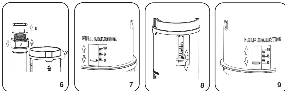
6. Para ajustar la altura del tubo de desborde, jale hacia abajo el seguro (a) para quitarlo. Ajuste la altura deseada del tubo de desborde (b). Coloque nuevamente el seguro (a) jalándolo hacia arriba.
