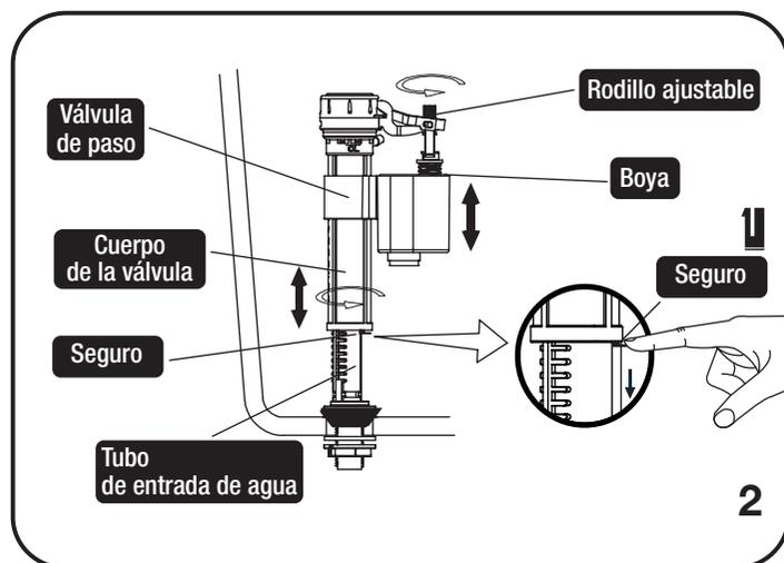
2. Ajuste el nivel de agua: Quite el seguro y gire el cuerpo de la válvula, levante el cuerpo hasta la altura deseada, gírela hasta que se escuche un click y vuelva a colocar el seguro.
