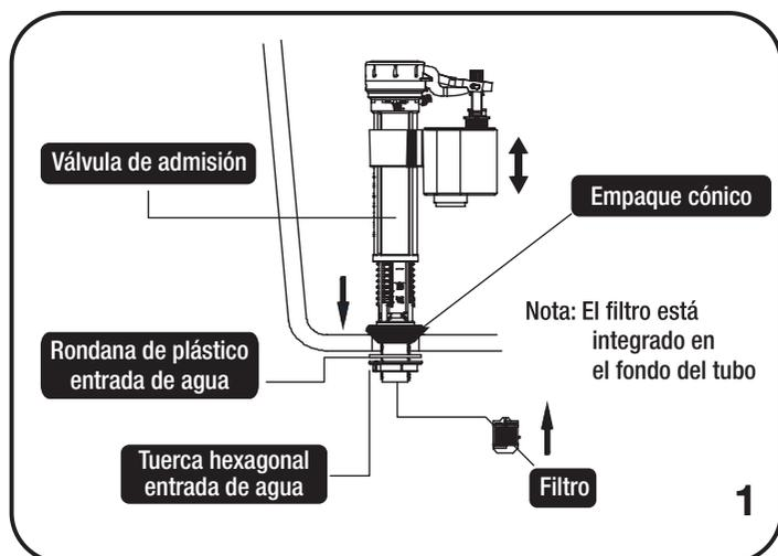
1. Coloque la válvula de admisión con el empaque cónico en el orificio de entrada del tanque. Sitúe este orden, en la parte baja de la válvula de admisión: la rondana plana y la tuerca hexagonal. Apriete la tuerca hexagonal haciendo contra en el tanque.
