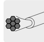
Cable de 1/4" (6 mm), recubrimiento de PVC, 7 x 19 hilos
