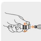
2 Conexiones rápidas de latón, 1/4"
