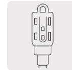
Aunque no tienen conectividad a tierra, su diseño permite conectar clavijas aterrizadas
