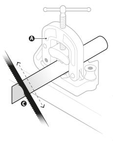
ATENCIÓN • Sujete firmemente el tubo con un tornillo de banco con mordazas para tubo (A) o una prensa de cadena para tubos (B). Si va a roscar un tubo ya instalado, asegúrese que se encuentra firme y que no se moverá.
